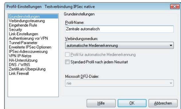
automatische Medienerkennung” aktiviert ist (Abb. unten). Außerdem müssen für das jeweilige Verbindungsmedium die Eingangsdaten zum ISP im Parameterfeld “Netzeinwahl” gesetzt sein.
