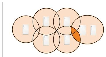
Um die Kosten für die Geräte sowie für Installation und Wartung gering zu halten, sollten so wenig wie möglich Basisstationen installiert werden.
