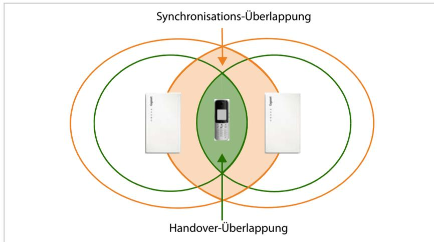
Es muss darauf geachtet werden, dass genügend große Überlappungszonen zwischen benachbarten Funkzellen bestehen. Für die Synchronisation darf der Empfang nicht so schlecht werden, dass sich die Basisstationen gegenseitig nicht mehr sicher empfangen. Für ein Handover muss ein Mobilteil eine Verbindung zu beiden Basisstationen in ausreichender Qualität haben. Informationen zu den erforderlichen Werten finden Sie im Abschnitt **Grenzwerte festlegen**, → **S. 21**.
