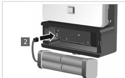
**Achtung:** Der Stecker ist so geformt, dass er nur in richtiger Richtung aufgesteckt werden kann. Gewaltames Anbringen des Steckers in falscher Position kann die Pins beschädigen und das Gerät unbrauchbar machen.
