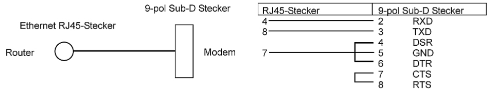
Abb. 47: PIN-Belegung Modemkabel
