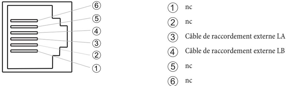
Les raccords La et Lb sont séparés de matière galvanique de la commutation de l'autocommutateur.
