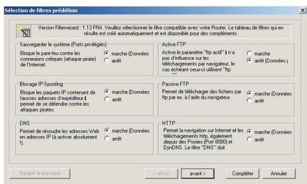
L'assistant de configuration de filtres peut être lancé à tout moment afin de charger une modification de configuration dans l'autocommutateur. Pour transférer et activer les filtres, cliquer sur la case Envoyer les données de configuration. La nouvelle configuration de l'autocommutateur est activée après avoir envoyé les données. Si une connexion Internet est cours, celle-ci sera coupée.
