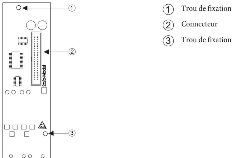
Le raccord à l'autocommutateur se produit à l'aide du câble plat livré. Le raccord des deux correspondants analogiques se produit sur les prises a/b5 et a/b6 de l'autocommutateur.
