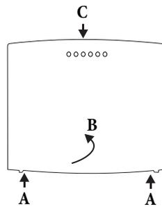
Ouverture de l'autocommutateur : »C« est le côté avant de l'autocommutateur. Tirez vers l'extérieure les deux ressorts en plastique qui portent un repérage jusqu'à ce que le couvercle se dégage. Soulevez-le »B« ensuite prudemment vers l'arrière. Ensuite, il est facile de le soulever. La barrette de raccordement est alors visible sous le couvercle du boîtier.
