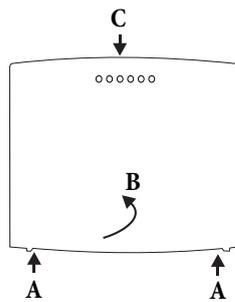
Öffnen der TK-Anlage: »C« ist die Vorderseite der TK-Anlage. Ziehen Sie die zwei gekennzeichneten Kunststoff-Federn »A« nach außen, bis der Deckel ausrastet. Heben Sie ihn »B« anschließend vorsichtig nach hinten ab. Anschließend lässt er sich leicht nach oben abheben. Unter dem Gehäusedeckel wird dann das Anschlussklemmenfeld sichtbar.
