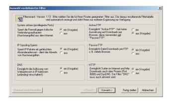
Der Filter-Wizard kann jederzeit erneut gestartet werden, um eine geänderte Konfiguration in die TK-Anlage zu laden. Zur Übertragung und Aktivierung der Filter betätigen Sie bitte die Schaltflächen »Senden« der Konfigurationsdaten. Nach dem Senden der Daten wird die neue Konfiguration in der TK-Anlage aktiviert, wobei eine bestehende Internetverbindung unterbrochen wird.
