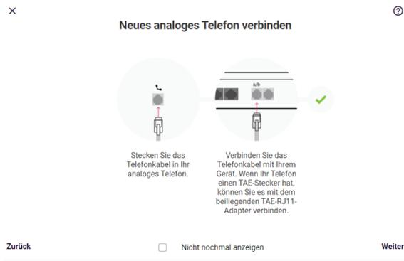
1. Schließen Sie Ihr analoges Endgerät direkt an einen analogen Anschluss (a/b1 bis a/b4) der be.IP swift an. Verwenden Sie dazu das dem Endgerät beigegefügte Kabel.
