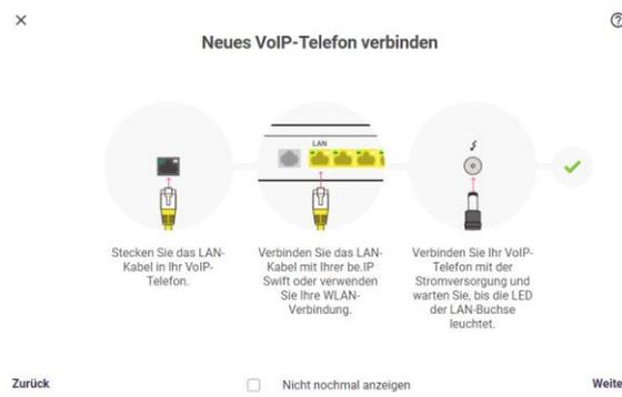
1. Schließen Sie Ihr VoIP-Telefon mit dem Ethernet-Kabel an einen LAN-Anschluss (LAN1 – LAN4) der be.IP swift an.
