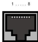
Die Pin-Zuordnung für die Ethernet 10/100/1000 Base-T-Schnittstelle (RJ45-Buchse) ist wie folgt:
