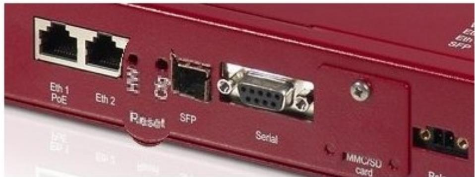
Abb. 10: Unterseite von **bintec WIx040n** mit den HW und Cfg Reset-Knopf
