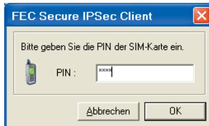
Die SIM-PIN muss nur dann eingegeben werden, wenn sie in der Konfiguration des Zielsystems (Profils) im Parameterfeld “Modem” im Telefonbuch noch nicht eingegeben wurde oder die abgespeicherte PIN nicht zur aktuell eingesetzten SIM passt.
