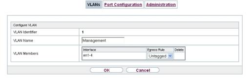
Fig. 69: LAN->VLAN->VLANs->New
