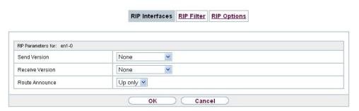
Fig. 101: Routing Protocols->RIP->RIP Interfaces->
