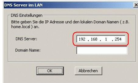
Abb. 9: Konfiguration -> Netzwerk -> Adresszuordnung -> DNS Server -> Erweitert
