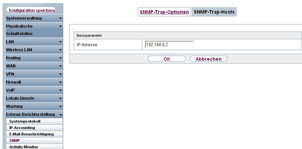
Abb. 159: Externe Berichterstellung -> SNMP -> SNMP-Trap-Hosts -> Neu
