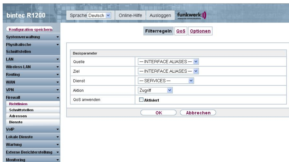
Abb. 148: Firewall -> Richtlinien -> Filterregeln -> Neu
