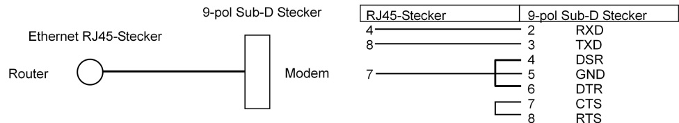
Abb. 76: PIN-Belegung Modemkabel
