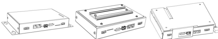
Abb. 12: Wandmontage bintec Wlx040n (Standardausführung, optional Hutschiene oder mit Diebstahlsicherung)
