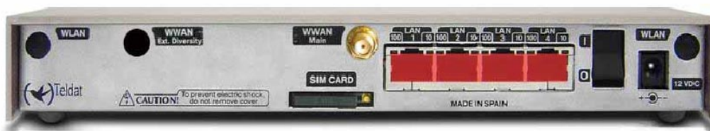
Fig. 3: LAN Switch ports (4)
