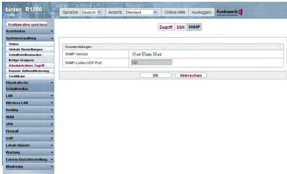
Abb. 50: Systemverwaltung -> Administrativer Zugriff -> SNMP
