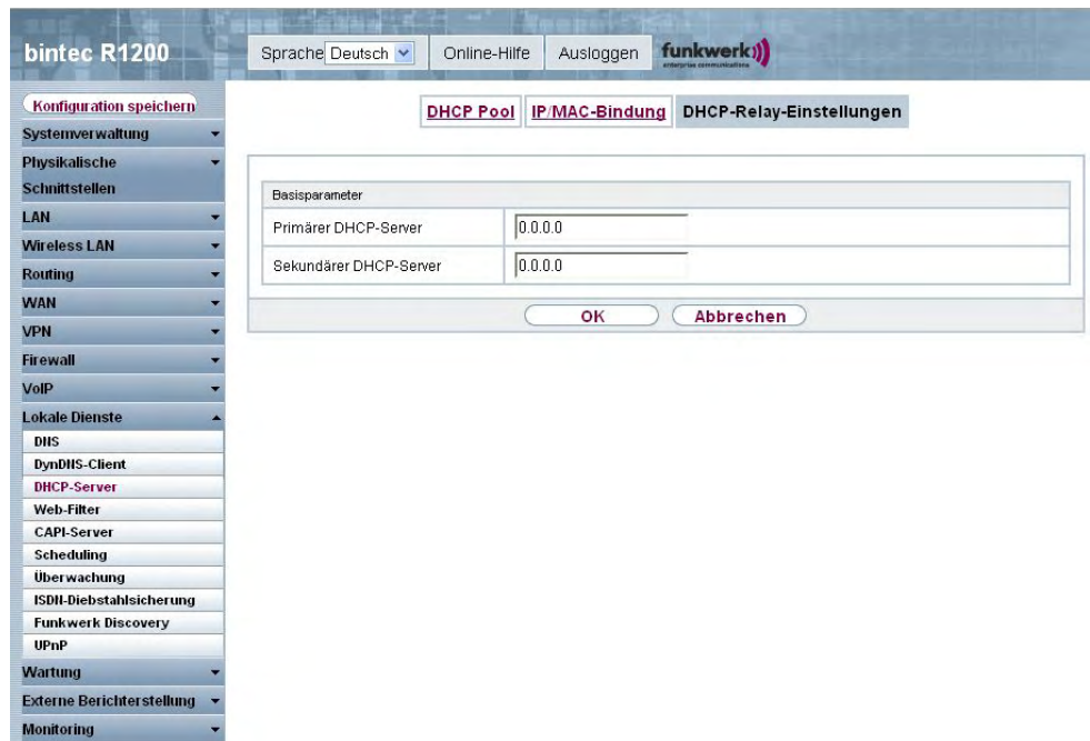
Abb. 152: Lokale Dienste -> DHCP-Server -> DHCP-Relay-Einstellungen
