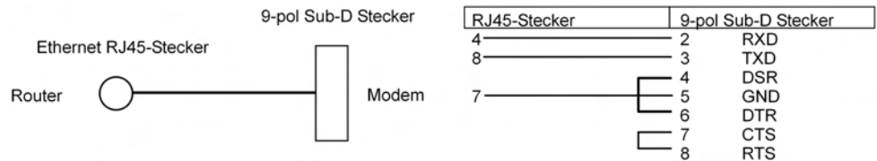
Abb. 53: PIN-Belegung Modemkabel
