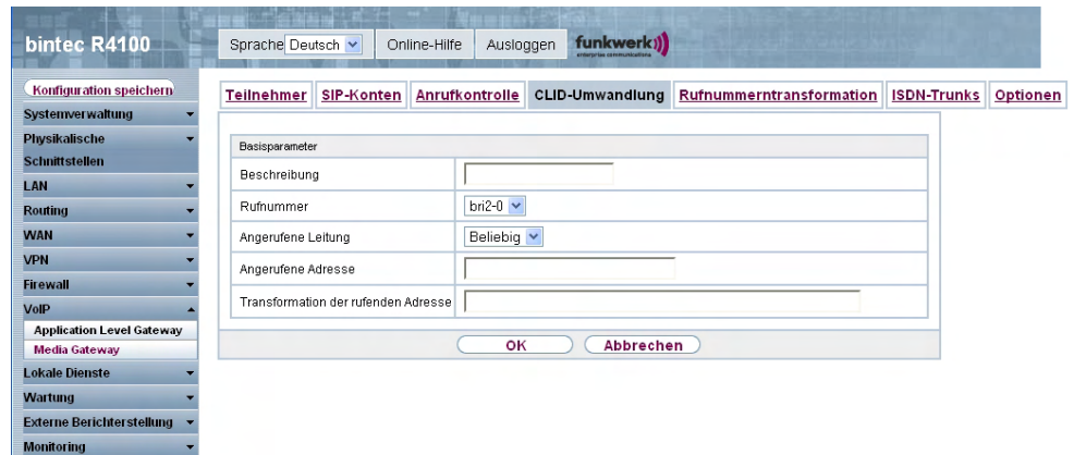
Abb. 139: VoIP -> Media Gateway -> CLID-Umwandlung -> Bearbeiten/Neu
