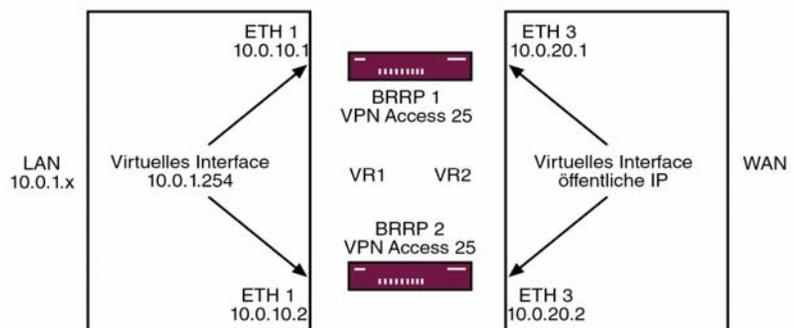
Fällt das Master Gateway aus, z.B. Hardwaredefekt, so übernimmt das Backup Gateway die Funktionalität des Master Gateways. Solange das Master Gateway aktiv ist, befindet sich das Backup Gateway im Hot-Standby-Modus. Durch ein konfigurierbares Regelwerk kann bestimmt werden, wie die Gateways sich bei einem Ausfall verhalten.
