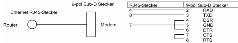
Abbildung 1-1: Spezifikation Kabel für die AUX-Schnittstelle zum Modem
