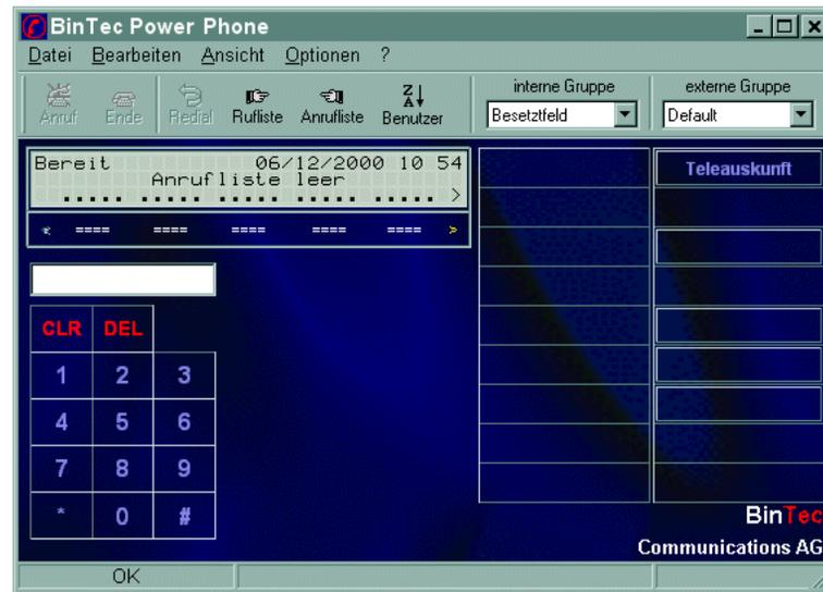
Bild 3-1: Die Grundansicht des BinTec **Power Phones**
