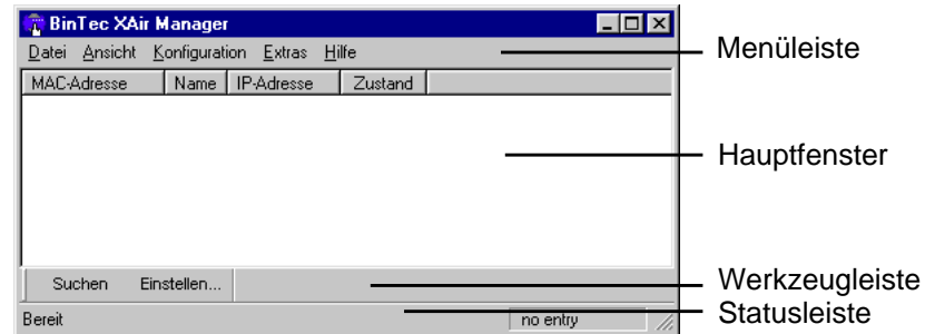
Bild 8-2: Die Oberfläche des BinTec XAir Managers
