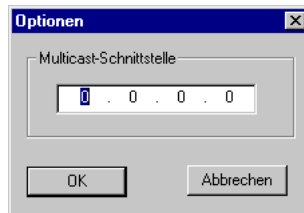
Bild 8-1: Eingabe der IP-Adresse für den Multicast-Router(-Switch)
