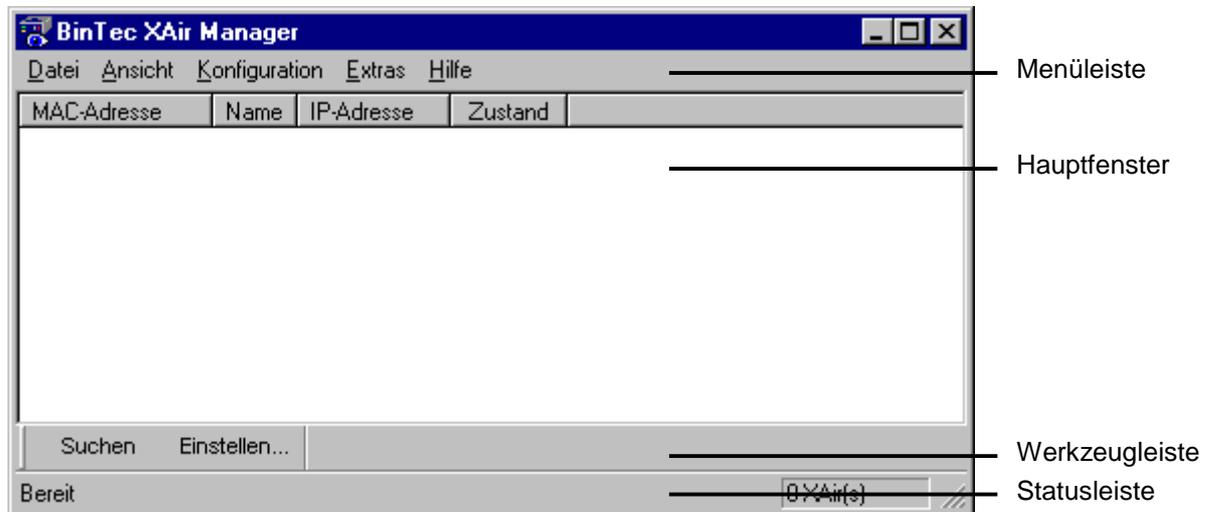
Bild 8-2: Die Oberfläche des BinTec XAir Managers
