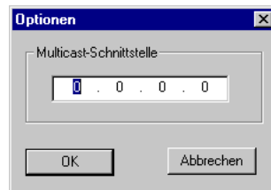
Bild 7-1: Eingabe der IP-Adresse für den Multicast-Router(-Switch)
