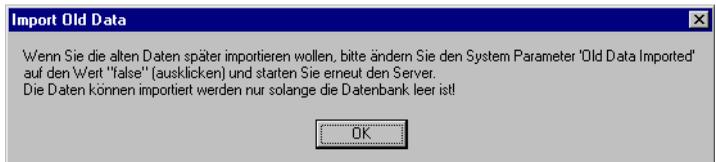
Um bei einem späteren Neustart des Servers die Abfrage nach dem Datenimport wieder zu aktivieren, müssen Sie in das Client Menü *Administration* > *System Parameter* das Attribut *Old Data Imported* auf den Wert "false" setzen (Haken in der Checkbox deaktivieren), Client und Server beenden. Beim nächsten Neustart des Servers werden Sie erneut gefragt, ob Sie die Daten importieren möchten.
