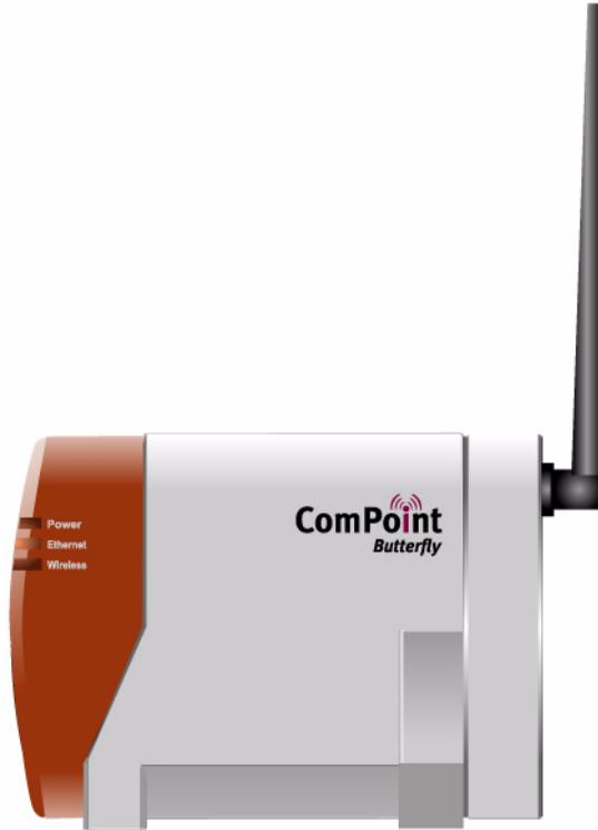
Vorn am ComPoint befinden sich drei LEDs zur Anzeige der Betriebszustände. Es werden die Zustände der Medien Ethernet, und Wireless dargestellt. Die LEDs leuchten grün.
