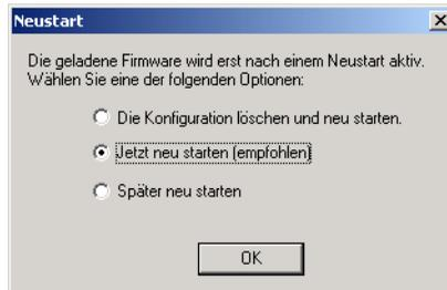
Sie haben hier die Wahl zwischen einem einfachen Neustart des Geräts oder dem gleichzeitigen Zurücksetzen der Konfiguration auf Werkseinstellung oder einem späteren Neustart.
