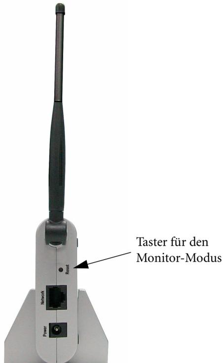
Der Monitor-Modus wird dann durch einen speziellen LED-Zustand angezeigt (siehe [Abschnitt Der ComPoint - Vorderansicht und LEDs, Seite 1–1](#)).
