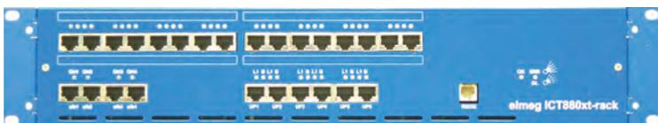
I pannelli frontali sono avvitati all'apparecchio con 6 viti. 4 viti sul lato frontale e 2 viti sul lato inferiore del pannello frontale.
