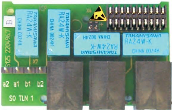
Il modulo NSP (alimentazione d'emergenza) consente di continuare ad effettuare chiamate tramite il centralino anche se è stata interrotta l'alimentazione di rete (230 V~). Il dispositivo terminale che permette di effettuare chiamate anche nel caso dell'interruzione dall'alimentazione deve disporre di una »alimentazione d'emergenza«.
