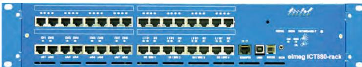
L'image suivante montre la platine avant de l'autocommutateur elmeg ICT880xt-rack en pleine configuration.
